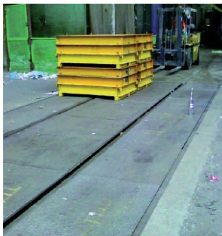
Prova di Eccentricità su una pesa a ponte da 80t eseguita con 12t di masse campione su ogni punto di appoggio
